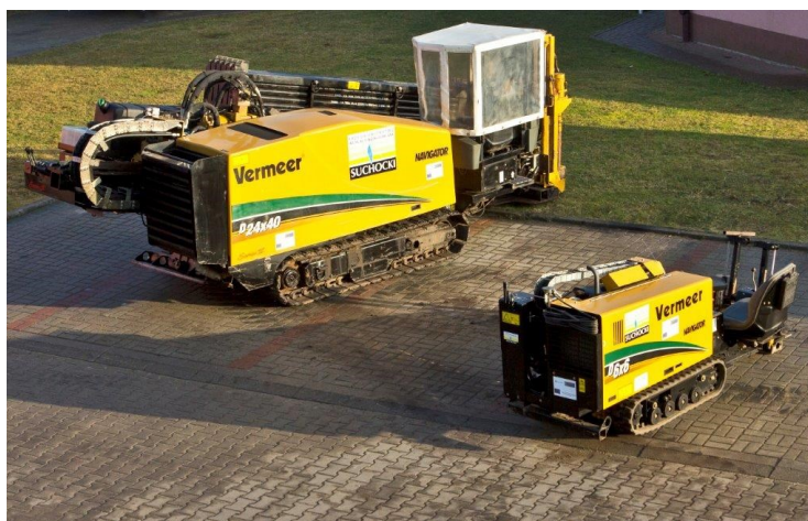
Wiertnica firmy Vermeer do wykonywania przewiertów horyzontalnych metodą bez wykopową.
