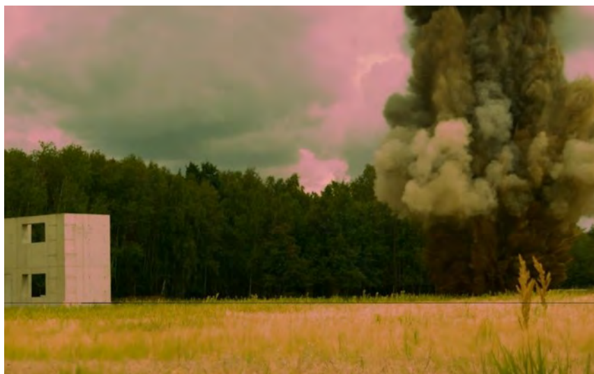
Zdj. 3. Detonacja ładunku w odległości 2m od schronu DN3000 z rury Weholite. Fot. Pelter
