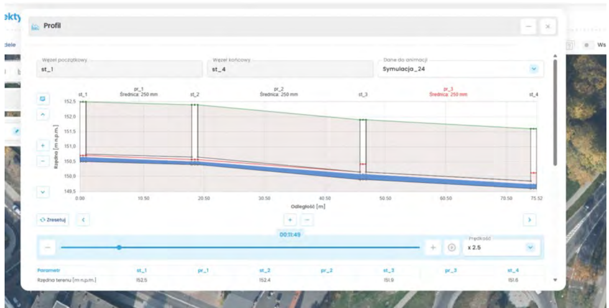
Fot. Wypełnienie przewodów widoczne na profilu podłużnym kanalizacji deszczowej
